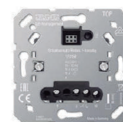
1701SE Релейная вставка 1-канальная ~ 230 V, 50Hz, для датчика движения A1180, A1180WW, A1180AL, DAW360WW, DAW360AL, PMU360WW, PMU360AL, необходим нейтральный проводник
