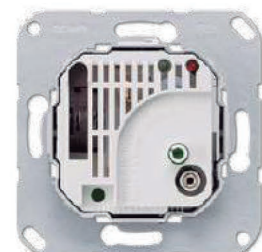
FTR231U Регулятор подогрева пола, однополюсный, НЗ контакт 10 А, 250 V-. В комплекте датчик температуры 4 м, 7,8 мм ø
