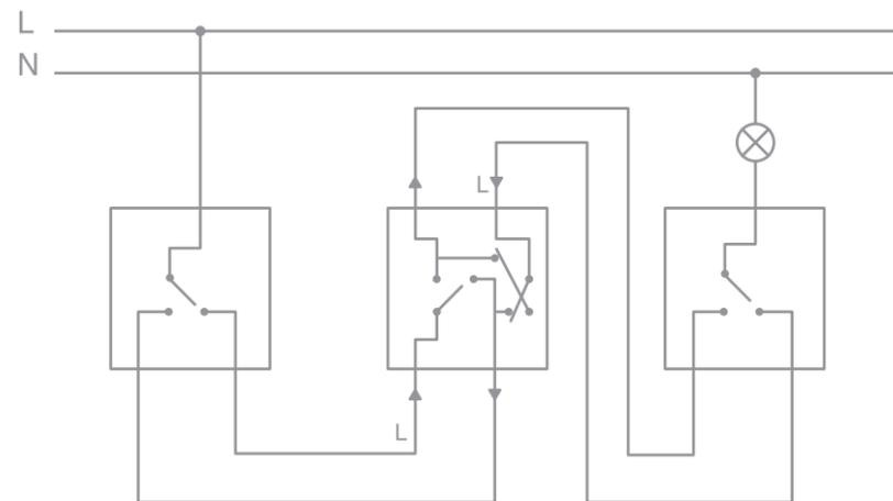
Схема подключения с трех мест с помощью двух одноклавишных перекрестных выключателей
