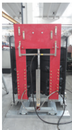
Реакторы применяются для создания в питающей цепи индуктивного сопротивления
