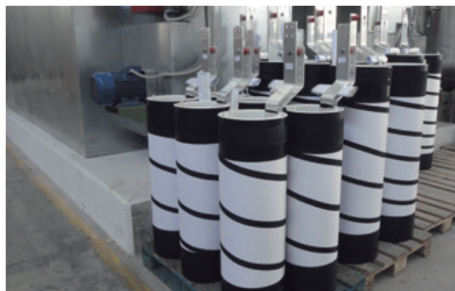
Обмотка низкого напряжения
